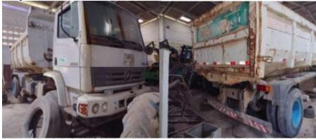
SITUAÇÃO DO VEÍCULO:SEM MOTOR, ESTOUROU O BLOCO, MAS COM ALGUMAS PEÇAS, CAIXA DE MARCHA NO LUGAR, PNEUS RUIM, MOTOR PRECISANDO DE ALGUNS REPAROS O QUE NÃO PERMITE O USO ADEQUADO DO VEÍCULO.
